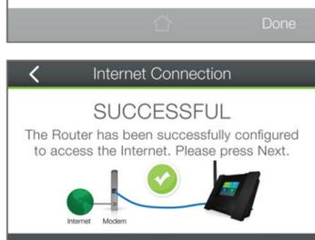
Si la detección de la conexión a Internet se ha realizado correctamente, usted verá una marca de verificación verde.
